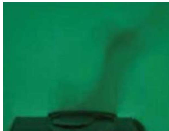
Εικόνα 5: Οι αόρατοι και επικίνδυνοι ατμοί υδράργυρου δημιουργούν σκιά σε φθορίζον πέτασμα, όταν αυτό φωτίζεται με υπεριώδη ακτινοβολία.
