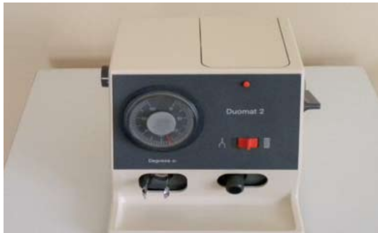
Εικόνα 1: Συσκευή ανάδευσης σκόνης κράματος μετάλλων και υδράργυρου για την παρασκευή αμαλγάματος
